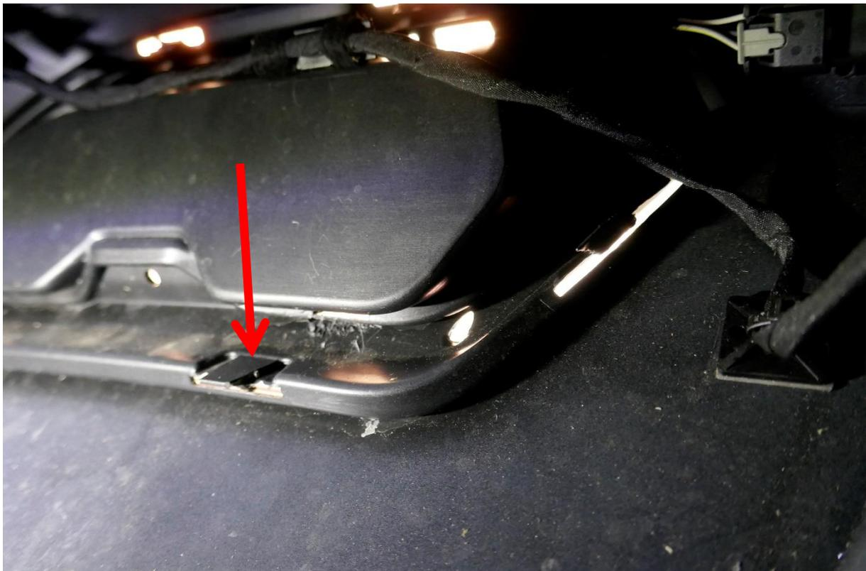
Durch die Öffnung der AHK hindurch, eine Taschenlampe legen. Die 6 Klipse (2x oben, unten und jeweils seitlich) müssen von innen mit dem 8mm Schraubendreher runtergedrückt werden (roter Pfeil). Gleich vorweg, das ist Fummelarbeit.
