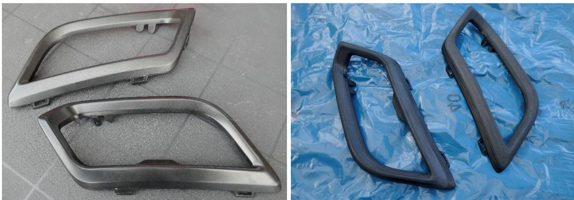
Die in schwarz metallic lackierten Blenden nun mit 200er Schleifpapier schleifen bis sie so aussehen. Das Anrauen hilft dem Haftvermittler und dem Filler besser am Untergrund zu haften. Den Haftvermittler dann aus circa 30 cm Entfernung auftragen und trocknen lassen. Danach den Filler auftragen, um Unebenheiten vom Schleifen auszugleichen. Zwischendurch immer wieder Abluftpausen machen, damit sich keine Nasen bilden.
