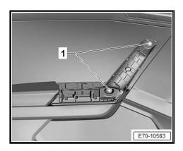
Die Türverkleidung -1- mit dem Keil -T10383- lösen. Am vorderen unteren Teil der Tür beginnen und den Keil in der Nähe der Halteclips -2- zwischen Türverkleidung und Tür einschieben.
